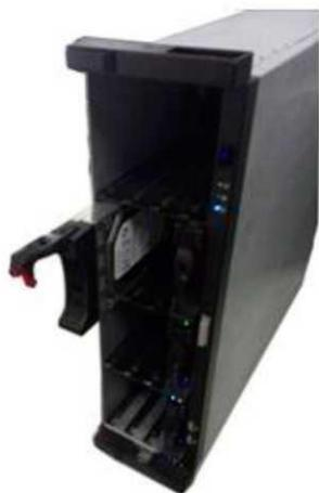
Поместите HDD в корпус на передней панели устройства
