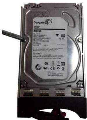
Используйте четыре винта, чтобы закрепить HDD
