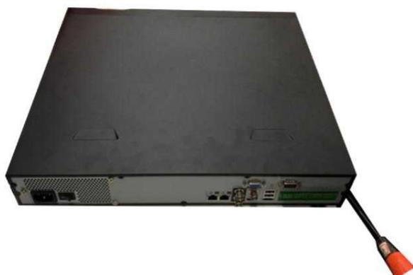
Используйте отвертку, чтобы освободить болты задней панели, далее снимите верхнюю крышку.
