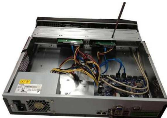
Положите HDD на кронштейн HDD, а затем совместите четыре винта с четырьмя отверстиями в HDD. Используйте отвертку, чтобы прикрутить винты, и закрепить жесткий диск на кронштейне HDD
