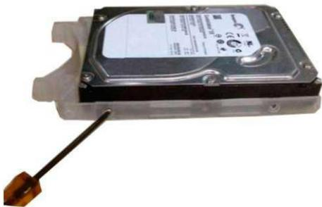
2. Используйте отвертку, чтобы зафиксировать ручку на HDD.
