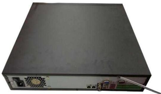
Используйте отвертку, чтобы освободить болты задней панели, далее снимите верхнюю крышку.
