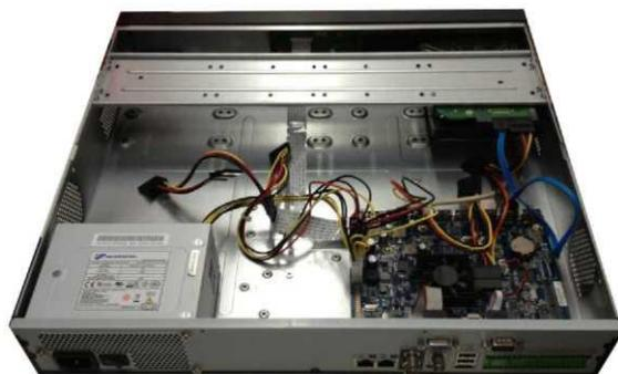
Соедините кабель данных HDD (жесткого диска) с основной платой и портом HDD (жесткого диска ) соответственно. Ослабьте кабель питания корпуса и соедините другой конец кабеля питания к порту HDD.
