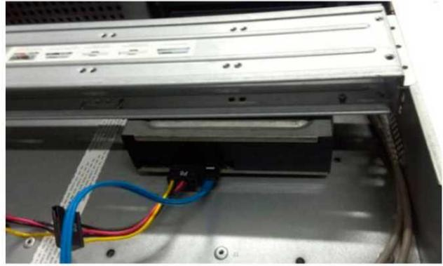
1. Откройте верхнюю крышку, а затем снимите кронштейн жесткого диска
