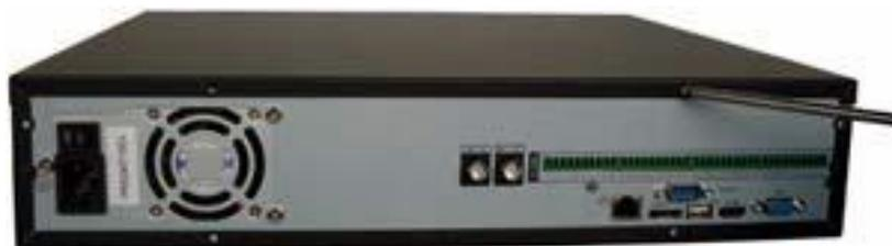
① Используйте отвертку, чтобы освободить винты на задней панели, а затем удалить переднюю крышку.
