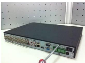
8. Завинтите болты на задней панели и боковой панели.
