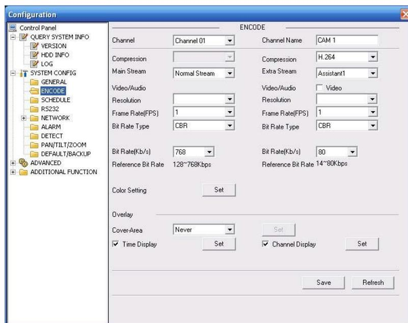
Рисунок 8-23 Настройка шифрования
