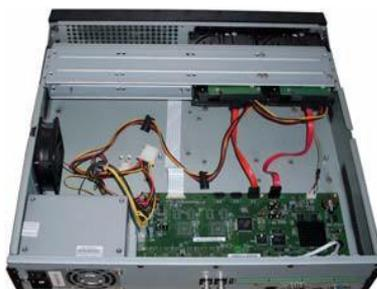
③ Подключите кабель данных жесткого диска к основной плате и порту НЖМД соответственно. Отключите силовой кабель корпуса и подключите другой конец силового кабеля к порту НЖМД.
