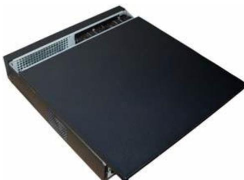
④ После подключения кабеля разместите переднюю панель на устройстве, затем закрутите винты задней панели.
