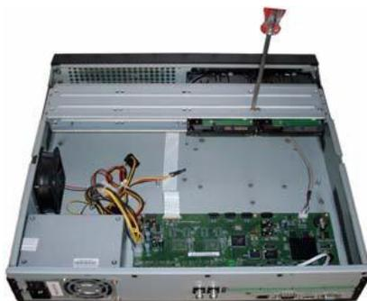
② Поместите НЖМД в скобу для НЖМД на корпусе, затем разместите четыре винта в четырех отверстиях жесткого диска. Используйте отвертку, чтобы надежно закрутить винты и закрепить жесткий диск в скобе.
