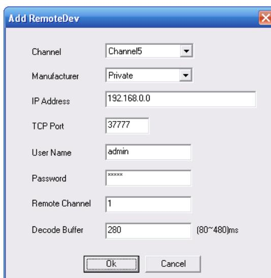
Рисунок 8-55 Добавление вручную
