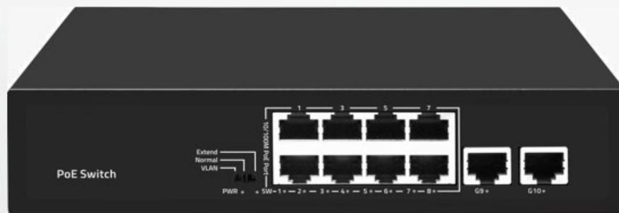
Назначение: 10 портовый коммутатор 8x100 Мбит/с PoE портов + 2x1000 Мбит/с порта Uplink. Режимы CCTV и VLAN. Порты с поддержкой PoE могут служить источником питания для устройств, поддерживающих стандарты IEEE802.3af и IEEE802.3at (таких как VoIP телефон, PoE точки доступа, IP-телефоны, камеры IP и т.д.). Встроенный блок питания, грозозащита и защита от статического электричества. Всё это существенно упрощает монтаж и позволяет решать большинство задач, стоящих перед системой видеонаблюдения.
