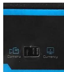
Режим Camera обеспечивается аппаратным VLAN, который обеспечивает режим безопасности в виде изоляции портов, блокирования широковещательных пакетов.
