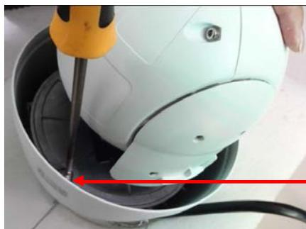
Ослабить винты горизонтальной панели (4 шт), и отодвинуть панель в сторону
