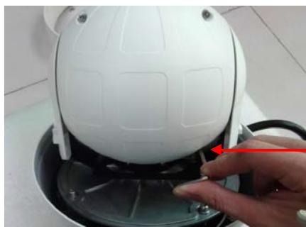
Ослабить винты задней крышки (4 шт), и снять крышку
